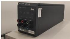
Patrón de magnitud Eléctrica, referencia en la medición de Tensión eléctrica.
